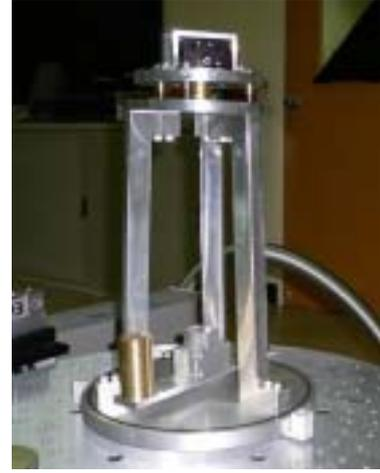
Fig. 1. Torsion strip pendulum
